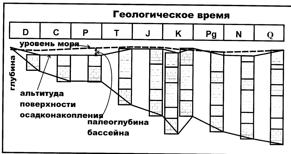
Рис. 6.3. Иллюстрация одномерной процедуры восстановления истории погружения по скважинным данным путем последовательного снятия слоев с учетом эвстатических колебаний уровня моря и палеоглубин бассейна
