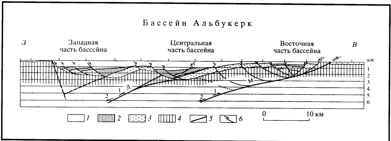
Рис.1.22. Разрез через впадину Альбукерк в южной части рифта Рио-Гранде, вдоль линии сейсмического профиля DECORP приблизительно на широте 34-30° с.ш. [Cabezas, 1989]
