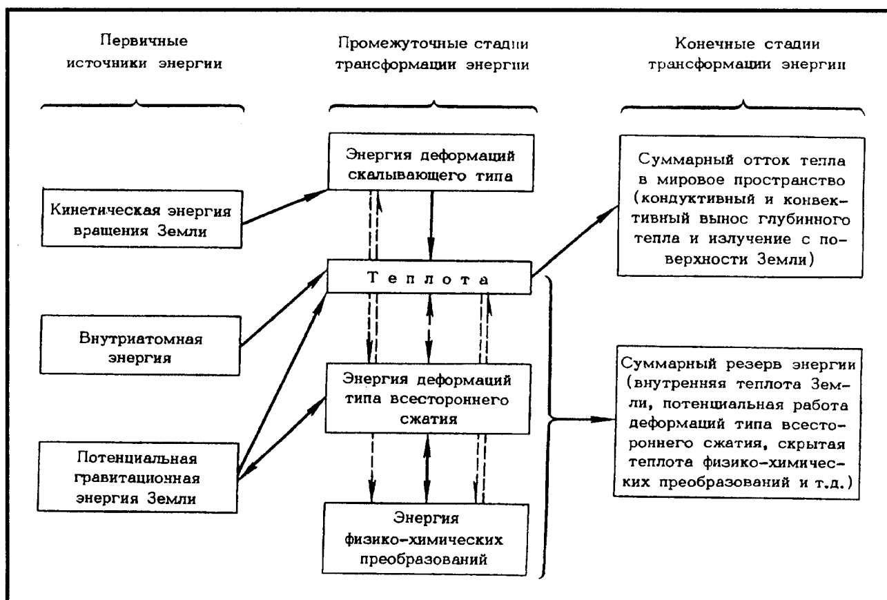
Рис. 4.4. Общая структура энергетического баланса Земли (сплошные стрелки – основные направления превращения энергии, пунктирные – второстепенные направления) [Поляк и др., 1972]
